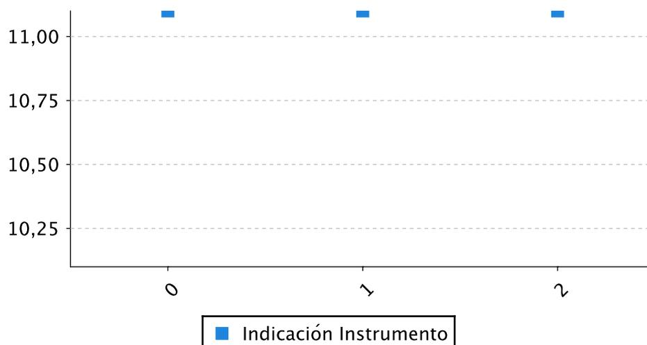
El porcentaje de error + incertidumbre (U) obtenido NO es permitido en detectores de gas portátil en base a las tolerancias descritas en el manual del equipo. Se requiere ajustar el equipo para disminuir el error del instrumento y efectuar una nueva calibración.
