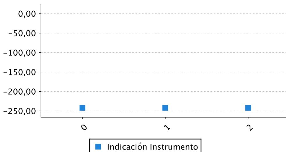
El porcentaje de error + incertidumbre (U) obtenido NO es permitido en detectores de gas portatil en base a las tolerancias descritas en el manual del equipo. Se requiere ajustar el equipo para disminuir el error del instrumento y efectuar una nueva calibración.
